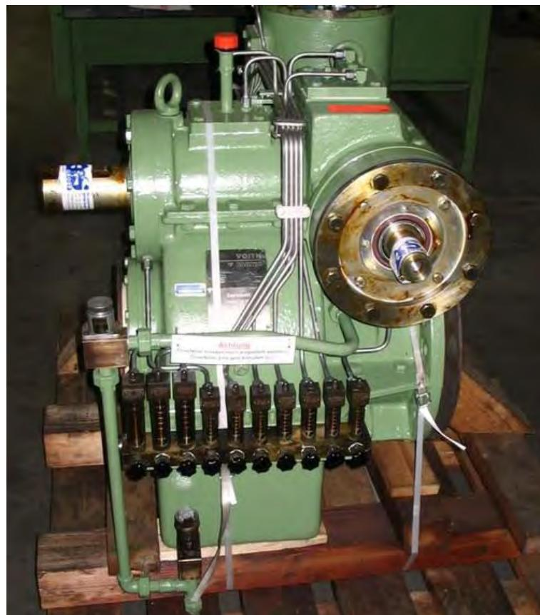
Wülfel - Kegelstirnradgetriebe KAU 24 Trockengruppenantrieb
