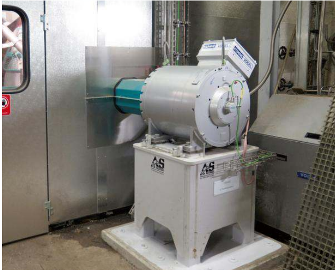
WebDrive®/Paper HT, wassergekühlter Synchronmotor in der Nachtrockengruppe, kompakt und energieeffizient.
