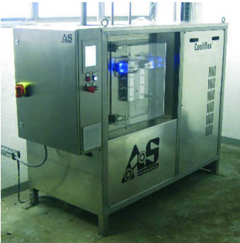
Abb. 5: Das Kühl- und Heizaggregat Cooliflex®
