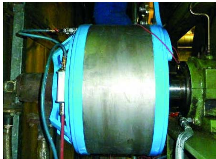
Abb. 11: Sogar der FlexoDrive® MIDI mit 70 kW hält den Bauraum ein!
