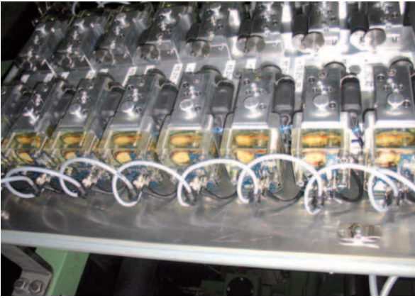
FlexoFlow-Durchflussregler im Verbund
