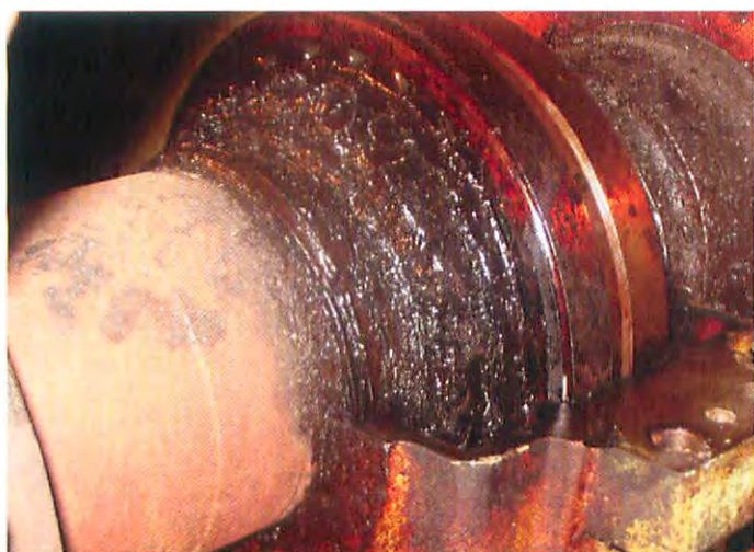
Mangelschmierung und Ölverkokung
